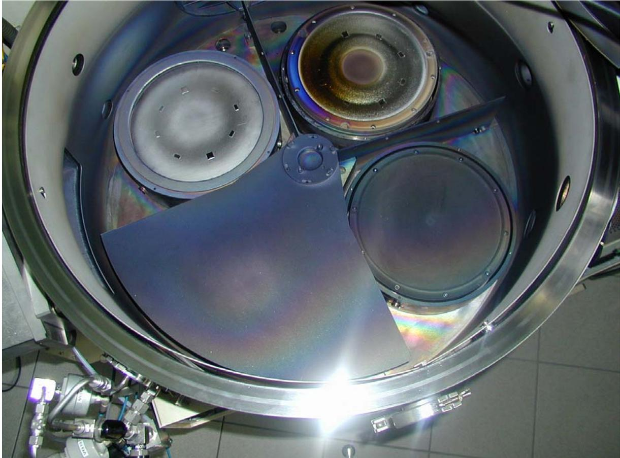
**Figure III-2- :** La forme des cibles du réacteur de pulvérisation cathodique magnétron.
