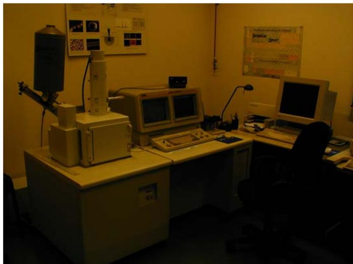
**Figure II-10- :** Le Microscope Electronique à Balayage.
