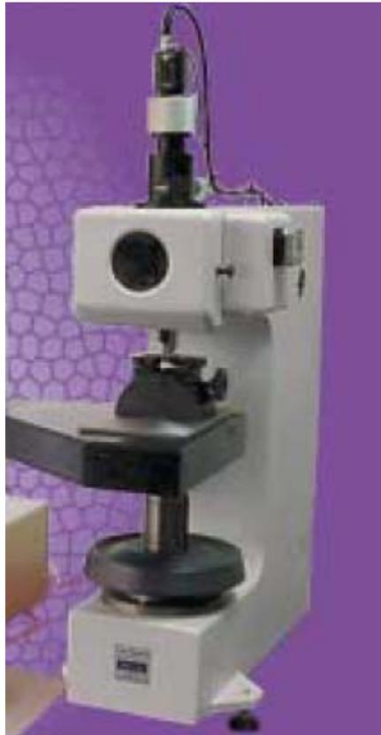
**Figure III-8-** : Appareil de la micro dureté.
