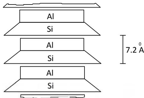
Figure 2.3 : Schéma de la particule de kaolinite.
