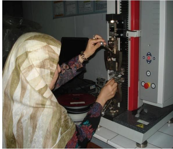
**Figure II-8** : Epreuve d'essai mise en place dans la machine de traction.
