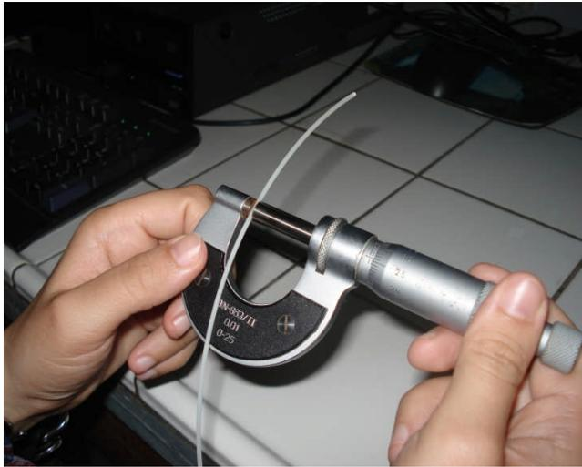
**Figure II-7** : Mesure des dimensions de l'éprouvette.
