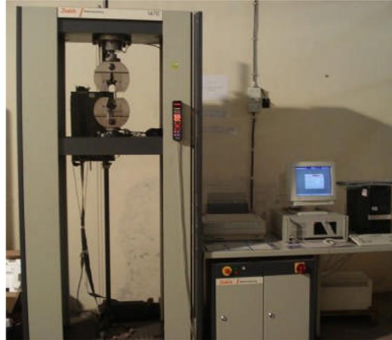
**Figure II-3 :** Photo de la machine de traction
