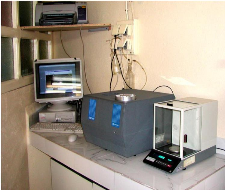
**Figure II. 12:** Analyseur de type SETARAM DSC 131 relié à un microordinateur.
