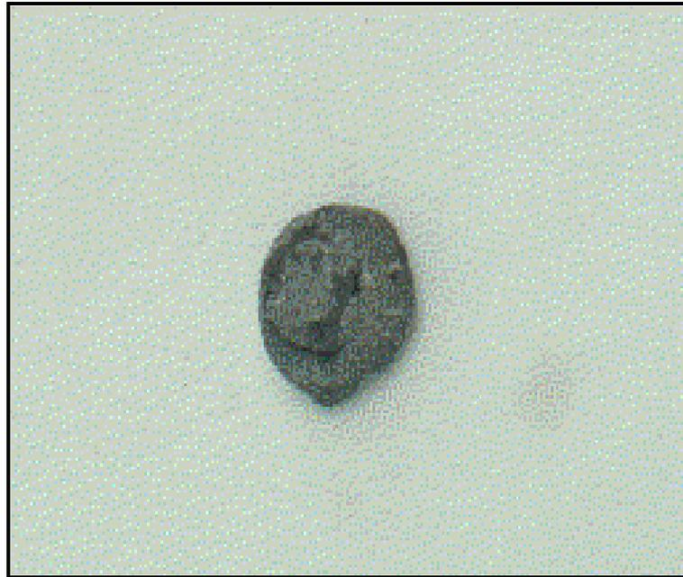
**Figure IV.15 :** Echantillon de  $\text{CuGaSe}_2$  présentant une solidification complète et une bonne morphologie.
