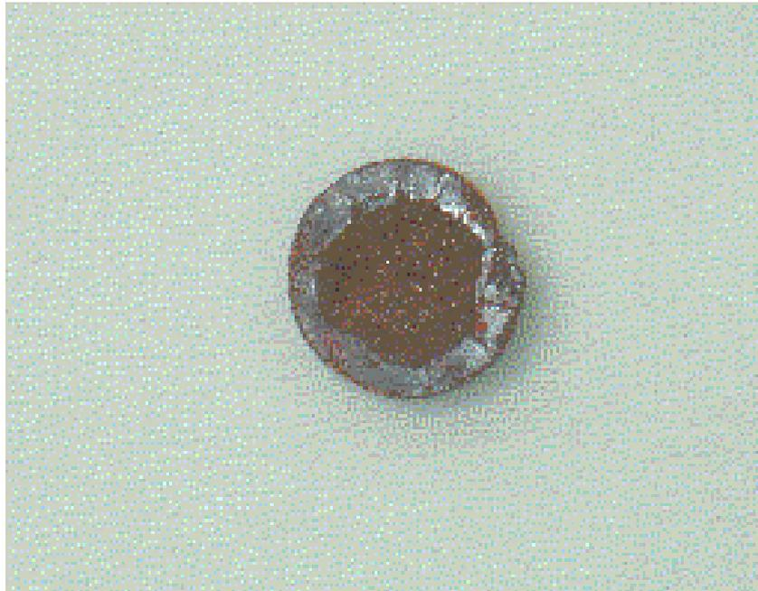
**Figure IV.9:** Echantillon de  $\text{CuGaSe}_2$  présentant une solidification partielle.
