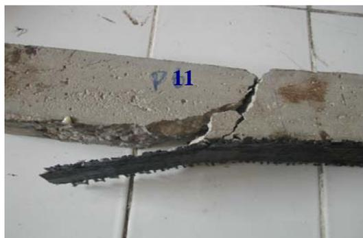
Fig (5-20) : rupture de la poutre P11
