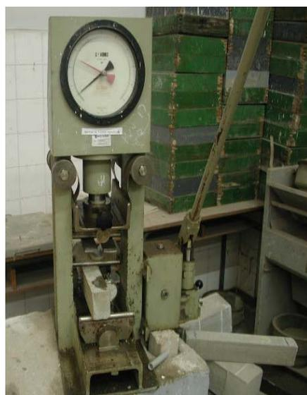
Fig 4-18: machine de flexion 3 points pour modèle réduit
