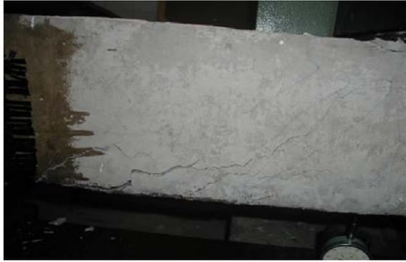
**Fig (5-25) : rupture de la poutre P2**
