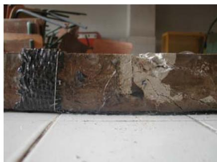
**Fig (5-26) : Rupture de la poutre P10**
