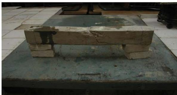
Fig (5-6) : rupture de la poutre P6
