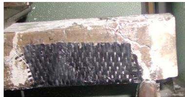
**Fig (5-27) : rupture de la poutre P9**
