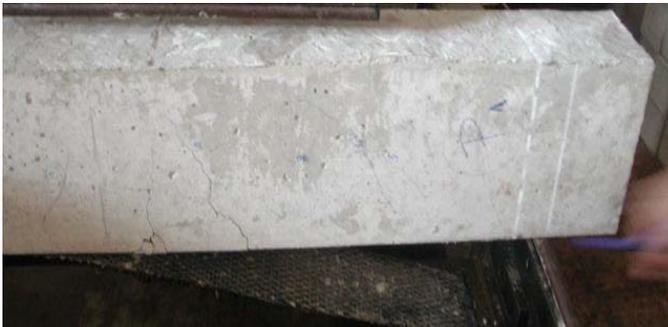
Fig(5-21) : rupture de la poutre P1
