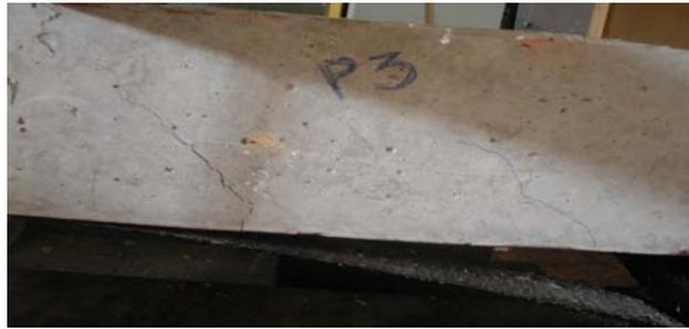
Fig(5-15) : fissure de la poutre P3
