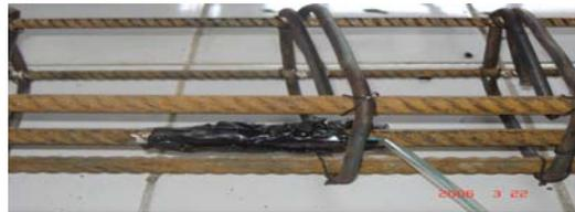
Fig(4-16) :photographie des jauge collé sur les aciers
