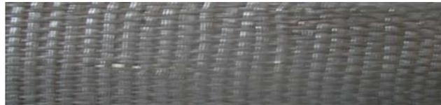
Fig (4-4) : tissu en fibre de carbone
