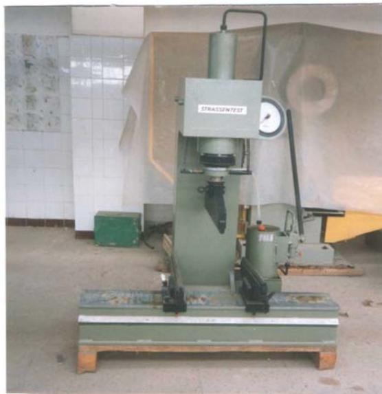
Fig 4-17 : machine d'essai en flexion 3 points
