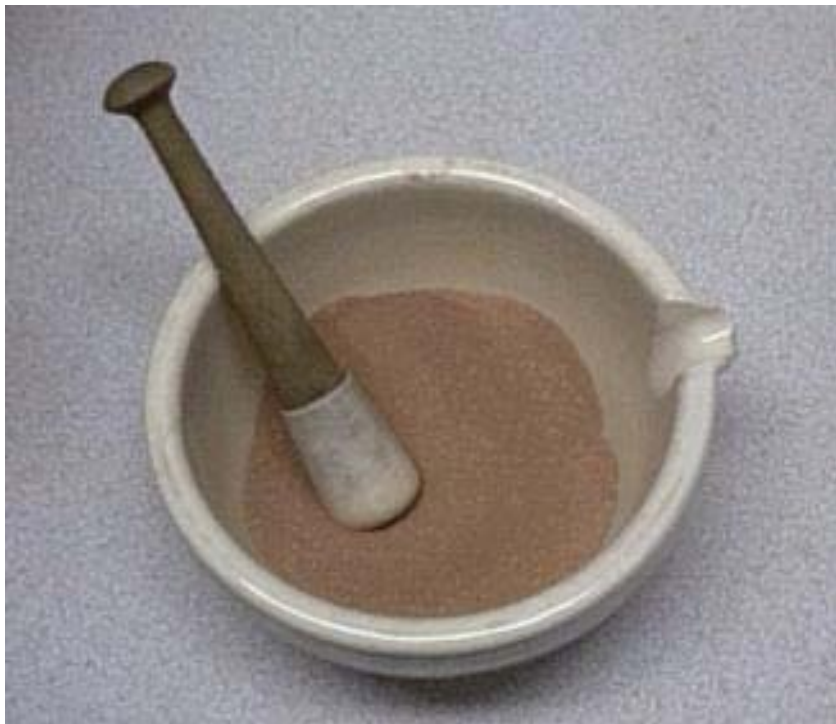
Fig. 4.3 Mortier et pilon en porcelaine pour l'écrasement du sable
