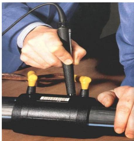
**Figure 2.20- crayon optique pour paramétrer le temps de soudage**
