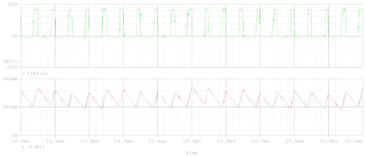
Figure 2.15 a) : Formes d'ondes de la tension et du courant de sortie d'un hacheur buck à MOSFET f=20\text{KHz}
