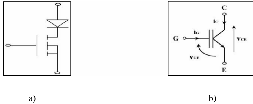
Figure 1.10: Schéma équivalent simplifié du composant IGBT et son symbole
