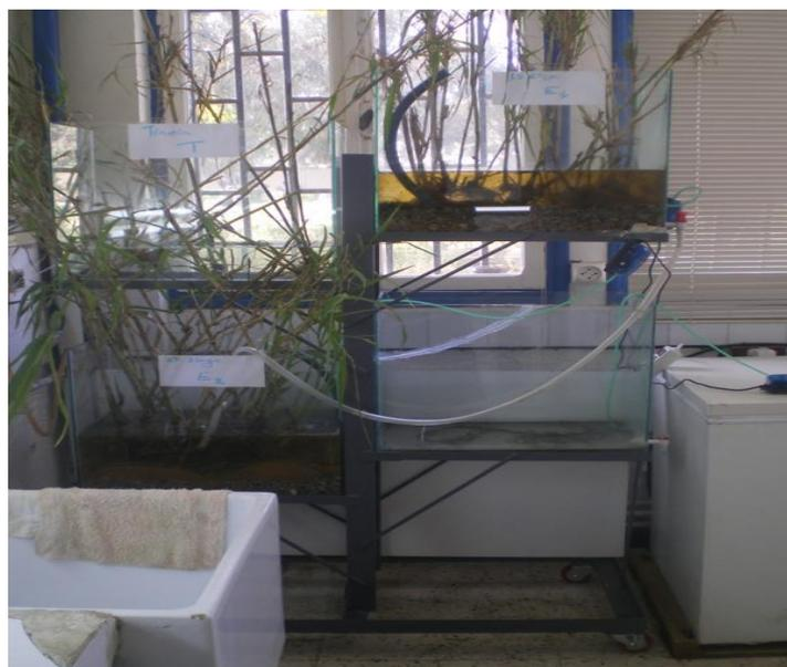
**Figure 4** : Système d'épuration (les deux étages d'épurations).
