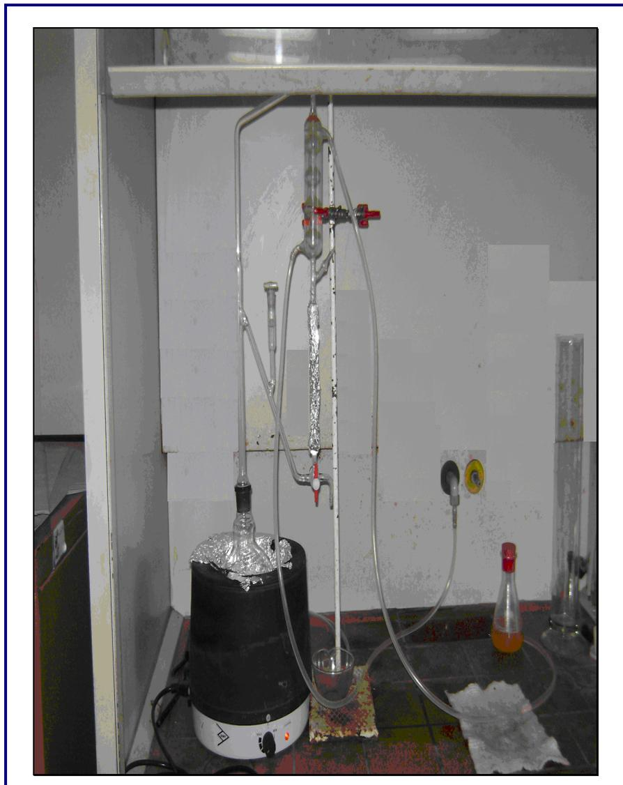
**Figure 13 :** Montage d'hydrodistillation employé pour l'extraction de l'huile essentielle.
