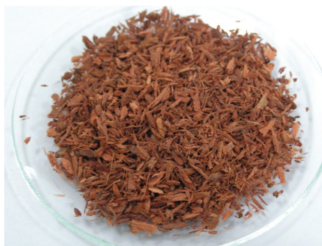
Figure III-1 : Structure macroscopique des particules des écorces d'eucalyptus.
