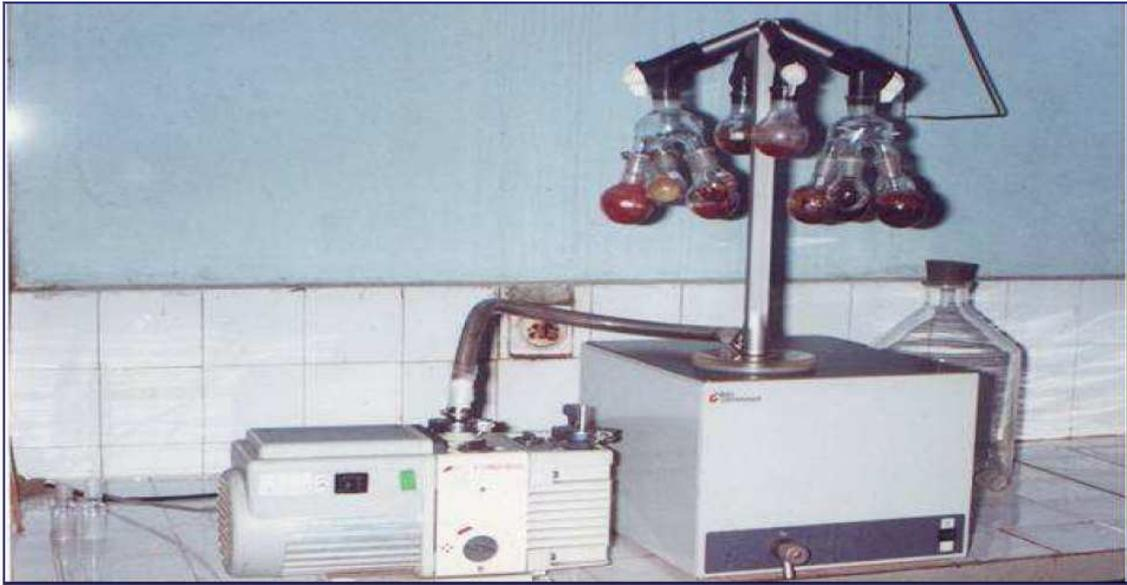
*Figure 12: Photo du Lyophilisateur utilisé pour sécher les extraits aqueux*
