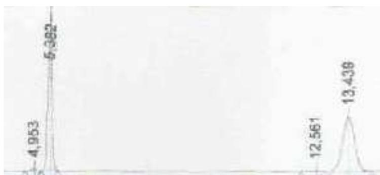
**Chromatogramme -6 :** Hydrolyse enzymatique de l'acétate **4a** avec 20 mg de CAL-B
