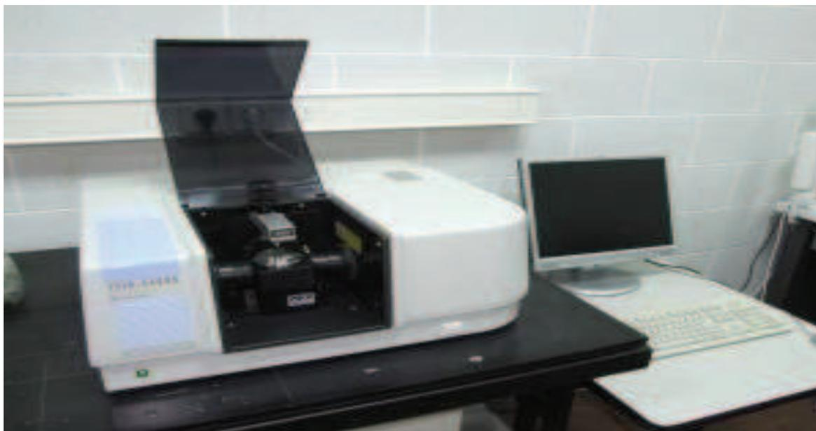
**Figure II. 17:** spectrophotomètre SHIMADZU (FTIR 8400)
