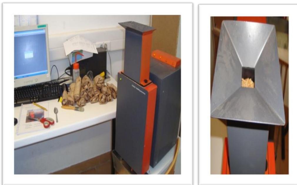
**Figure 28:** photos de l'appareil NIRS
