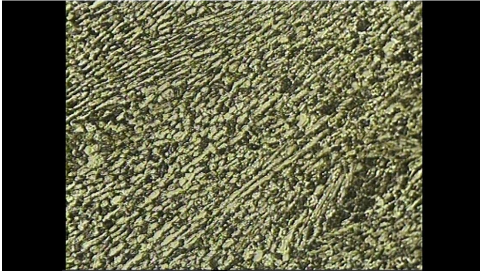
Figure AII.3 : micrographie de TA6V échantillon déformé à grande vitesse 4648 \text{ s}^{-1} ; Agrandissement X 200
