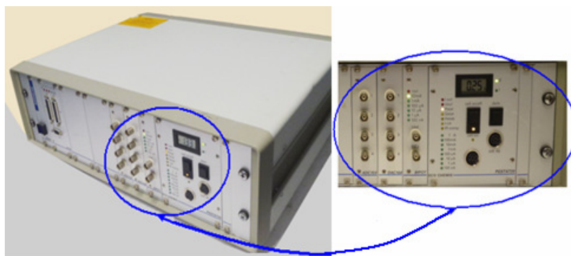
Figure V-2 : Potentiostat/Galvanostat du type AUTOLAB PGSTAT20
