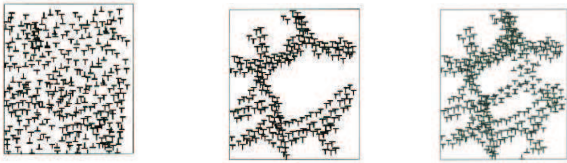
Figure I.8 : Représentation schématique de la restauration dynamique au cours de la déformation à chaud [32].
