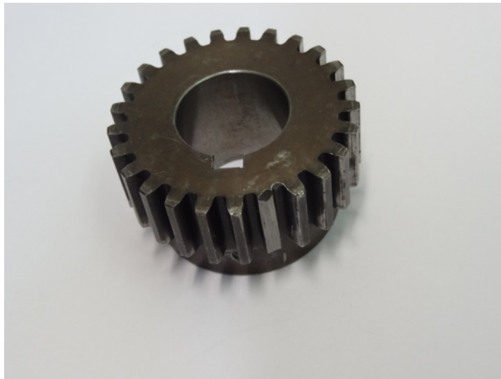
FIGURE 4.3 – Pignon défectueux ( DDL )
