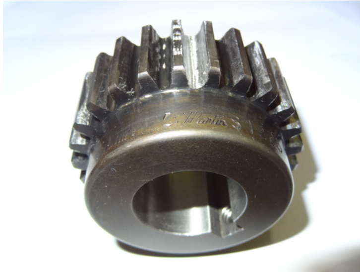
FIGURE 4.4 – Pignon défectueux (UG)
