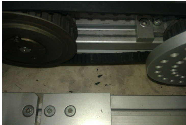
FIGURE 3.64 – Défaut sur la denture de la courroie
