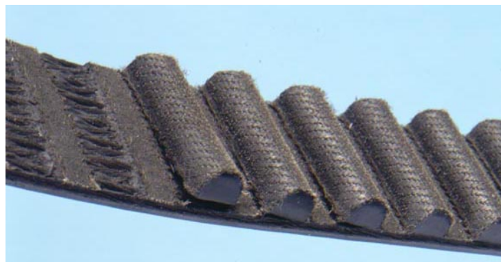
FIGURE 1.9 – Défaut de courroie "Partie arrachée"
