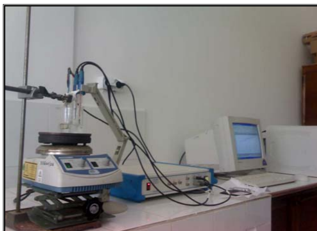
Figure IV.9 : Dispositif pour tracé les courbes d'impédance.
