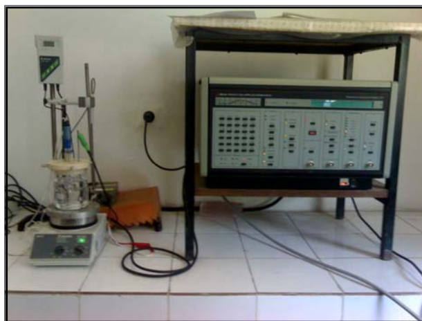
Figure IV.8 : Montage pour tracé les courbes de polarisation électrochimiques.
