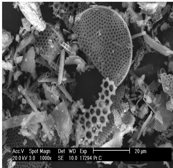
Figure 22 : Observation microstructurale de diatomite avec différent grossissement
