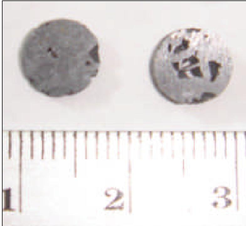
**Figure 3.40:** Surface des échantillons CIGS suite aux étapes de polissages.
