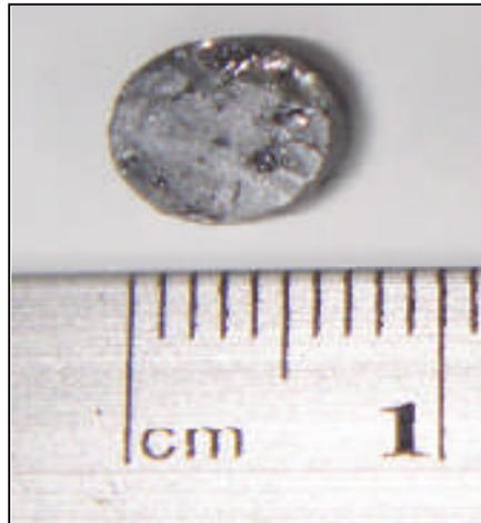
**Figure 3.38** : Image de la surface de l'échantillon CIGS suite à la découpe.
