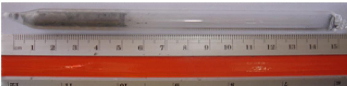
**Figure 3.27 :** Photo de tube après extraction du four élaboré suivant le cycle optimisé.
