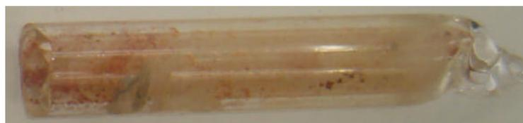
**Figure 3.15 :** Photo représentant le dépôt rouge sur les parois intérieures supérieures du tube.
