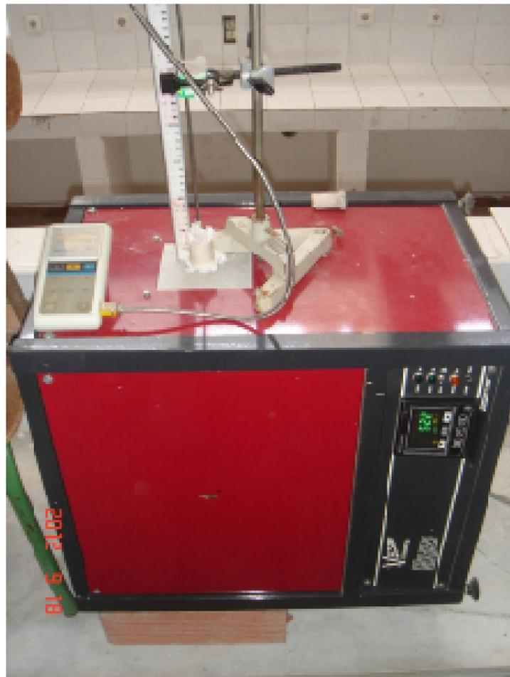
**Figure 3.9** : Montage utilisé pour la prise de mesure et l'étalonnage du four.
