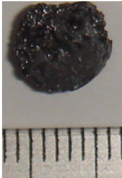
**Figure 3.14:** Echantillon  $\text{CuInGaSe}_2$  élaboré en utilisant le 1<sup>er</sup> cycle de croissance.
