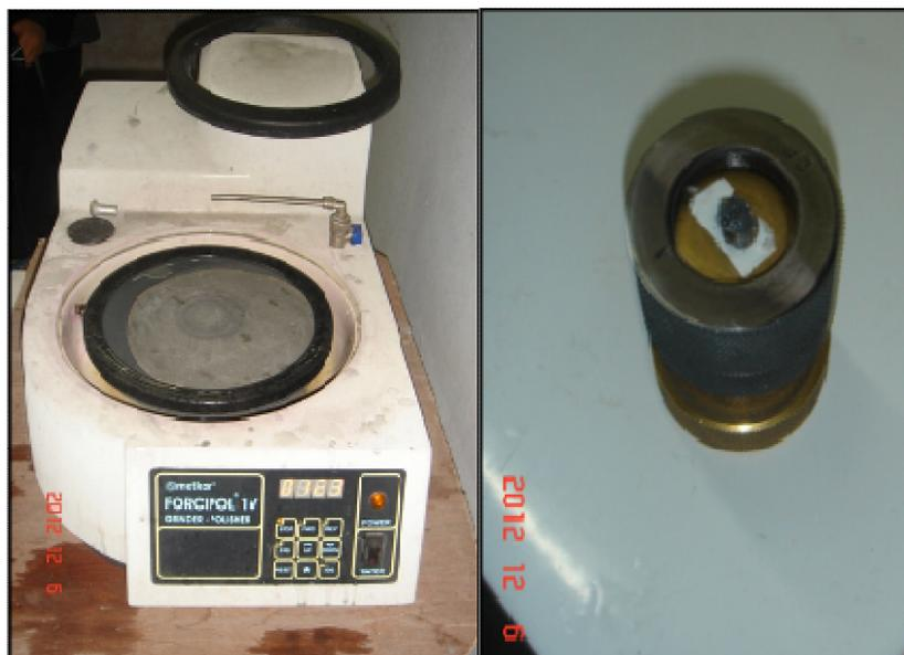
**Figure 3.39** : A gauche la machine de polissage et à droite le porte échantillon.
