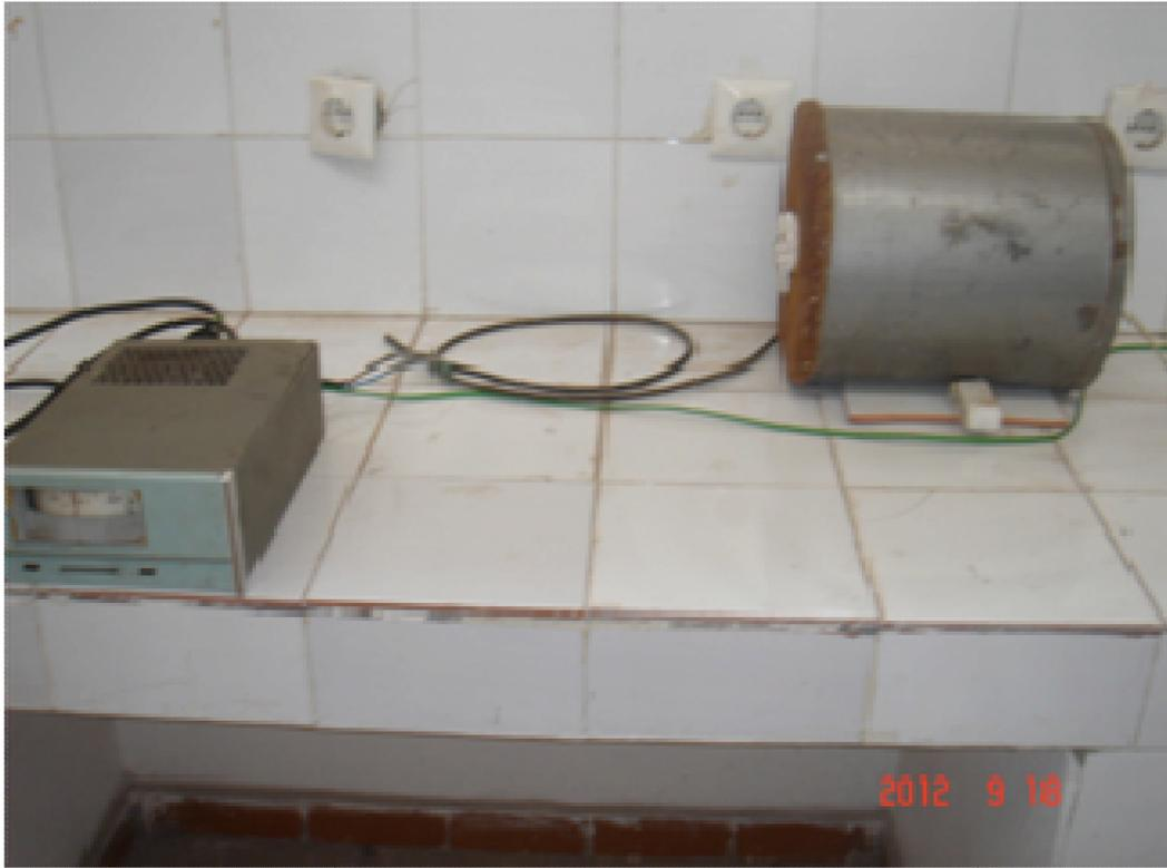
**Figure 3.6 :** Four utilisé pour le séchage des tubes.
