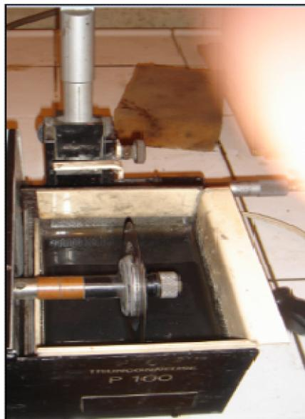
**Figure 3.37 :** Tronçonneuse utilisée pour la découpe des échantillons CIGS pour les mesures électriques.
