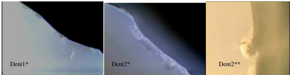
Figure 5.6: Phénomène de compétitivité de l'usure et de la fatigue sur les roues dentée * après 375000 cycles, l'entaille a disparu générant un même profil de l'usure sur les dents 1 et 2 ** dent 2 avec entaille avant essai de fatigue
