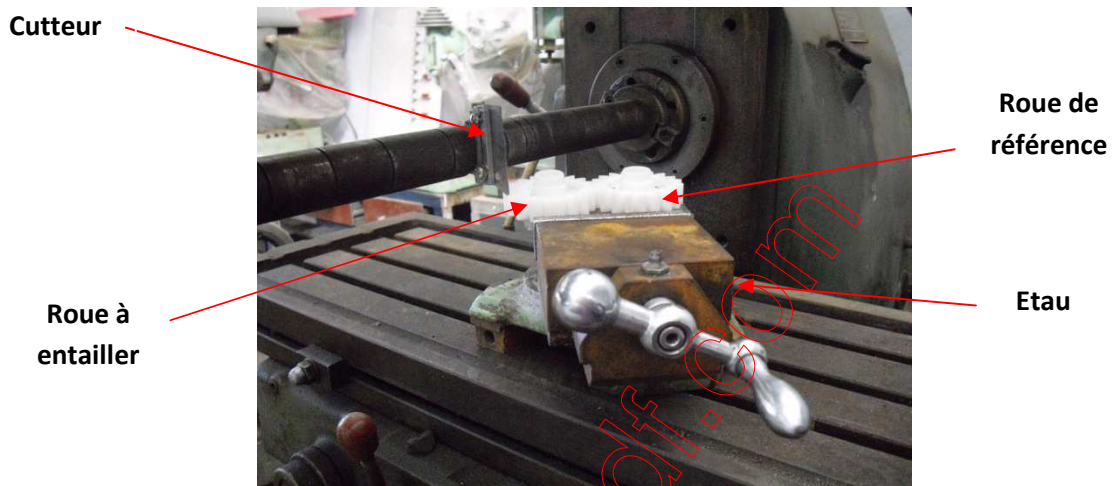
Figure.4.7 : Fraiseuse avec un coupeur comme outil de coupe avec dispositif de montage
