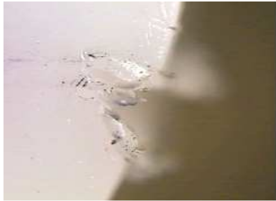
Figure 4.5 : Bourrage de la matière au fond de l'entaille
