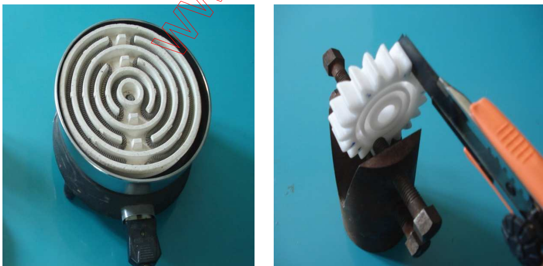
Figure .4.4: Pré-fissuration avec un cutter à chaud
