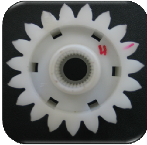
Figure 4.1 : Pignon usé en PA66 après 3 millions de cycle pour le cas d'eau
