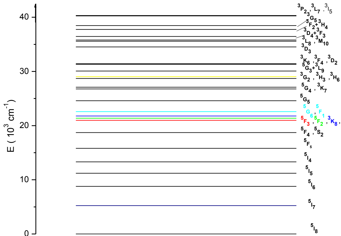
Figure I.2 : Diagramme d'énergie de l'ion \text{Ho}^{3+}
