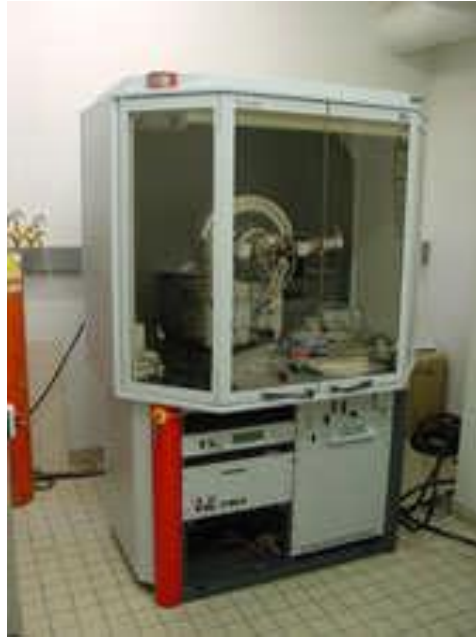
Figure. III-2 : Image du diffractomètre de type BRUKER-AXS type D8. Laboratoire des Couches Minces, Surfaces et Interfaces - Université Mentouri - Constantine
