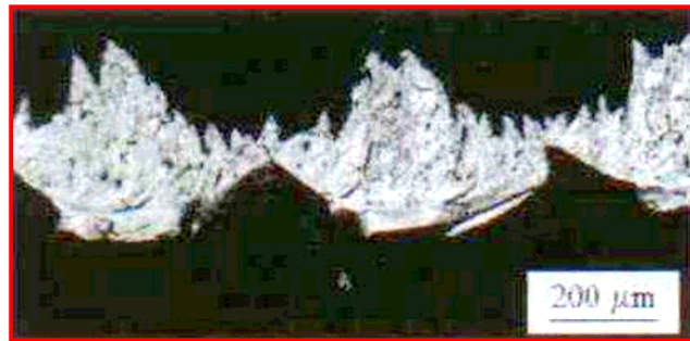
Figure I.18 Copeau d'acier inoxydable de géométrie continue (Outil cermet, V_c = 300\text{ m/min} , f = 0,05\text{ mm/tr} ).
