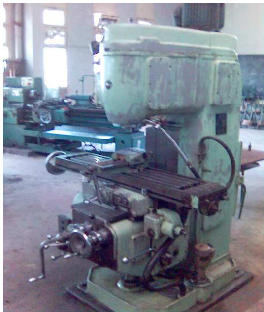
Figure II.1 - Fraiseuse verticale, modèle 6H11
