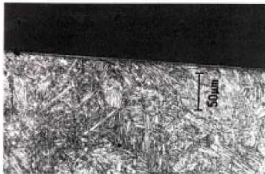
Figure I.18 Microstructure de la surface d'un acier 32 CrMoV 13 (Hv270) usinée à l'outil céramique à 300 m/min et 0,2 mm/tr D'après [42].
