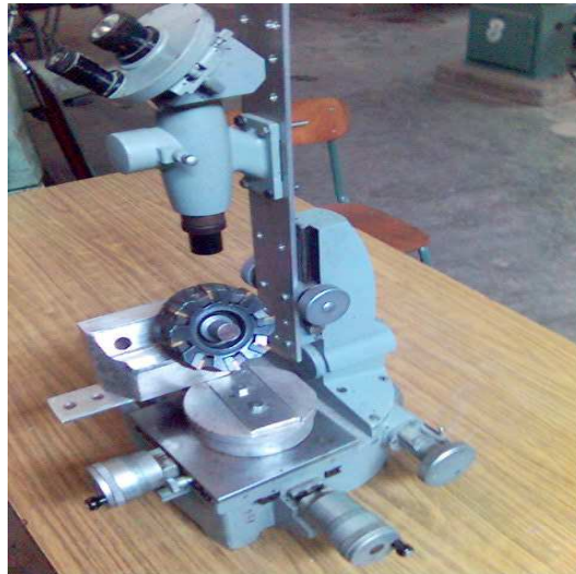
Figure II.6 - Microscope optique modèle MMN-2
