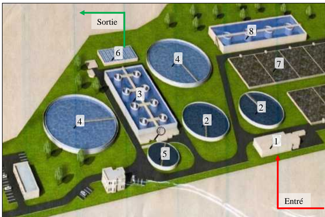
[1 : Prétraitement, 2 : Décanteur primaire, 3 : Bassin d'oxygénation, 4 : Clarificateur, 5 : Épaississeur, 6: Bassin de désinfection, 7 : Lit de séchage, 8 : Boue secondaire].
