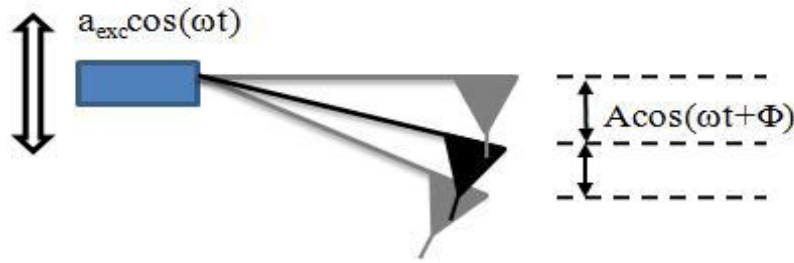
Figure 3.16 : Schéma de l'excitation du système pointe-levier. a_{exc}(t) est le déplacement de la céramique piézo-électrique excitatrice, oscillant à la pulsation \omega . A est l'amplitude d'oscillation du système pointe-levier.
