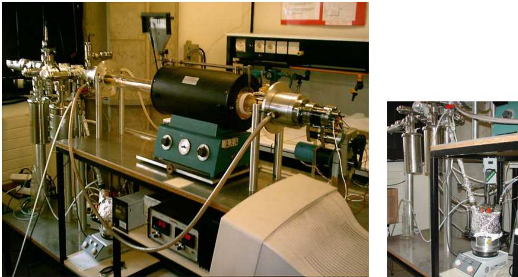
Figure III.7 : Installation expérimentale de corrosion sous contrainte mécanique appliquée. Liaison du dispositif de génération de la vapeur d'eau avec l'installation (photo à gauche).
