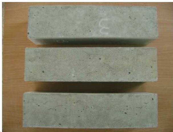
Figure IV.3.2. Les chantillons pour le retrait (3 prismes de 7x7x28 cm)
