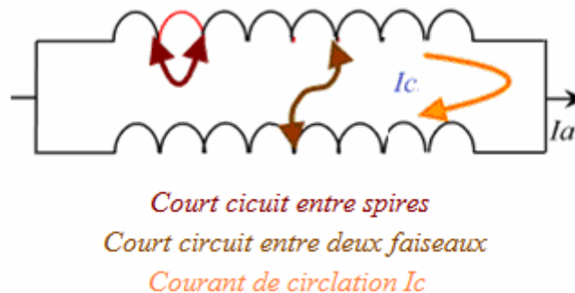
Fig 1.5 Présentation d'un court circuit dans une bobine
