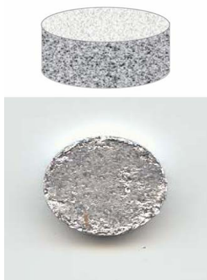
Figure II-4. Pastille d'un mélange homogène compactée de poudres à base d'aluminium.
