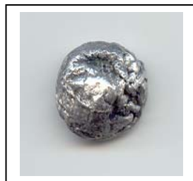
Figure II-8. Echantillon d'alliage à base d'aluminium élaboré par fusion HF.
