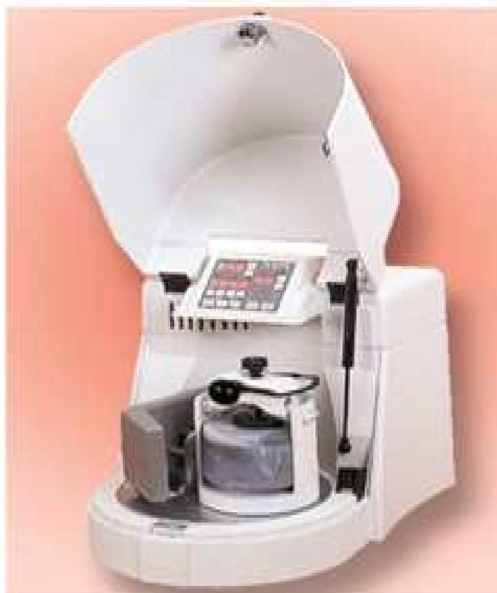
**Figure II.2:** Photo du broyeur planétaire utilisé (type Fritsch P-6) pour l'obtention de  $\text{CuInSe}_2$  en poudre (méthode "mécano-synthèse").
