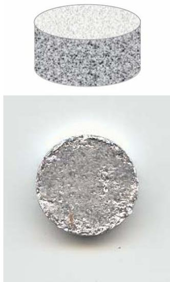
Figure II-4. Pastille d'un mélange homogène compactée poudres à base d'aluminium.
