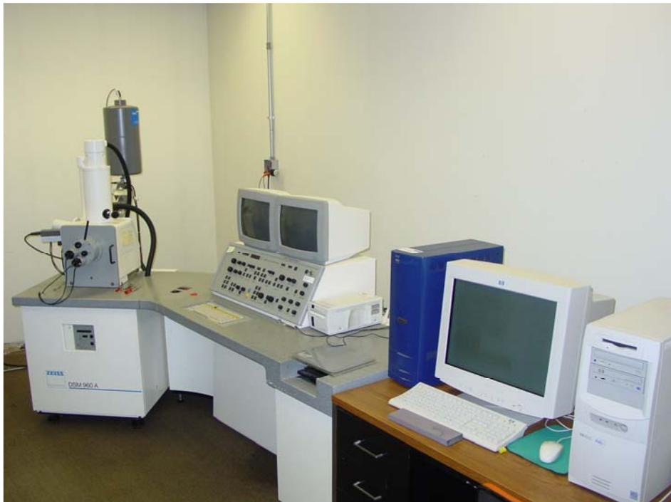
Figure III-18 : photo de la microscopie électronique à balayage MEB type DSM Zeiss 960 A
