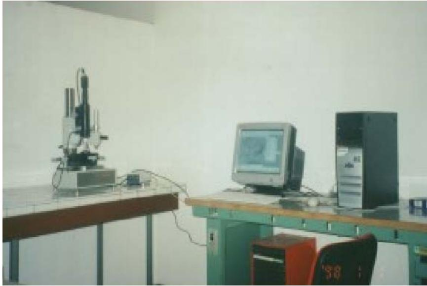
Figure. IV-7. Photo de l'ensemble microduromètre Vickers et PC.
