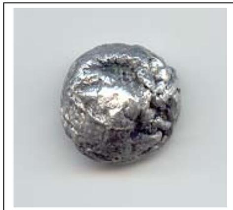
Figure II-8. Echantillon d'alliage à base d'aluminium élaboré par fusion HF.
