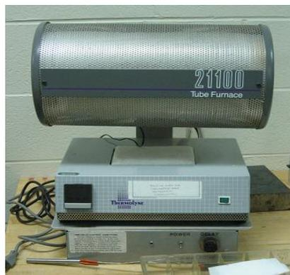
Figure V-1. Four de traitement thermique.
