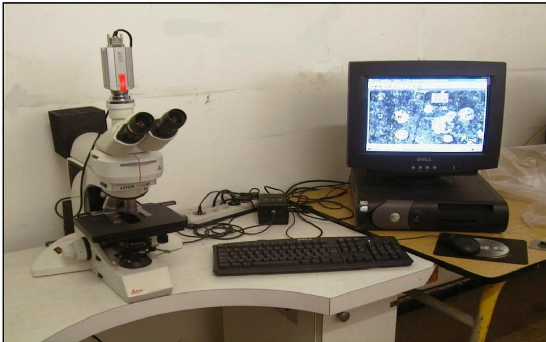
Figure III-10. Photo du dispositif d'observation optique.
