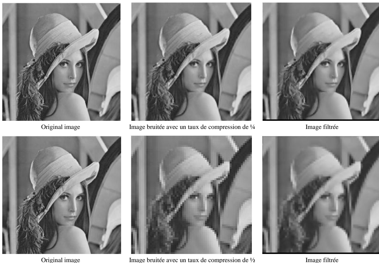
Figure 5.28. Utilisation du filtre anti-blocs sur des images réelles.
