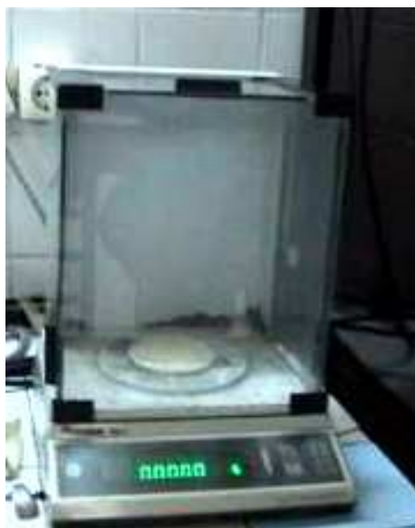
Figure III-12- balance analytique de ( 10^{-4} g) de précision.
