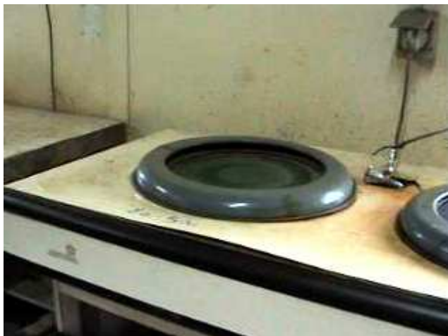
Figure III-11- polisseuse tournante à différentes vitesses
