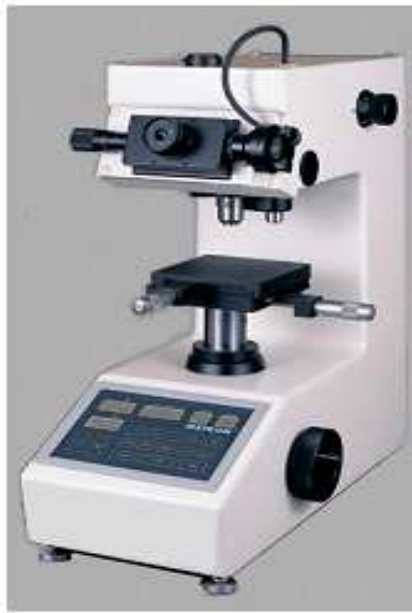
Figure III-6- Microduromètre Vickers Matsuzawa MXT70 de la série MXT70
