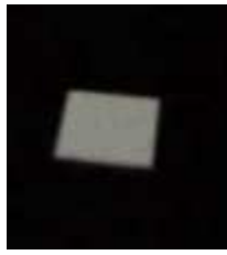
Figure III-1- échantillon d'alumine pour l'essai d'indentation.
