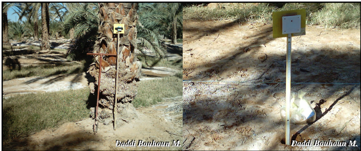
Photo VI 1. Tarière et sonde électrique
