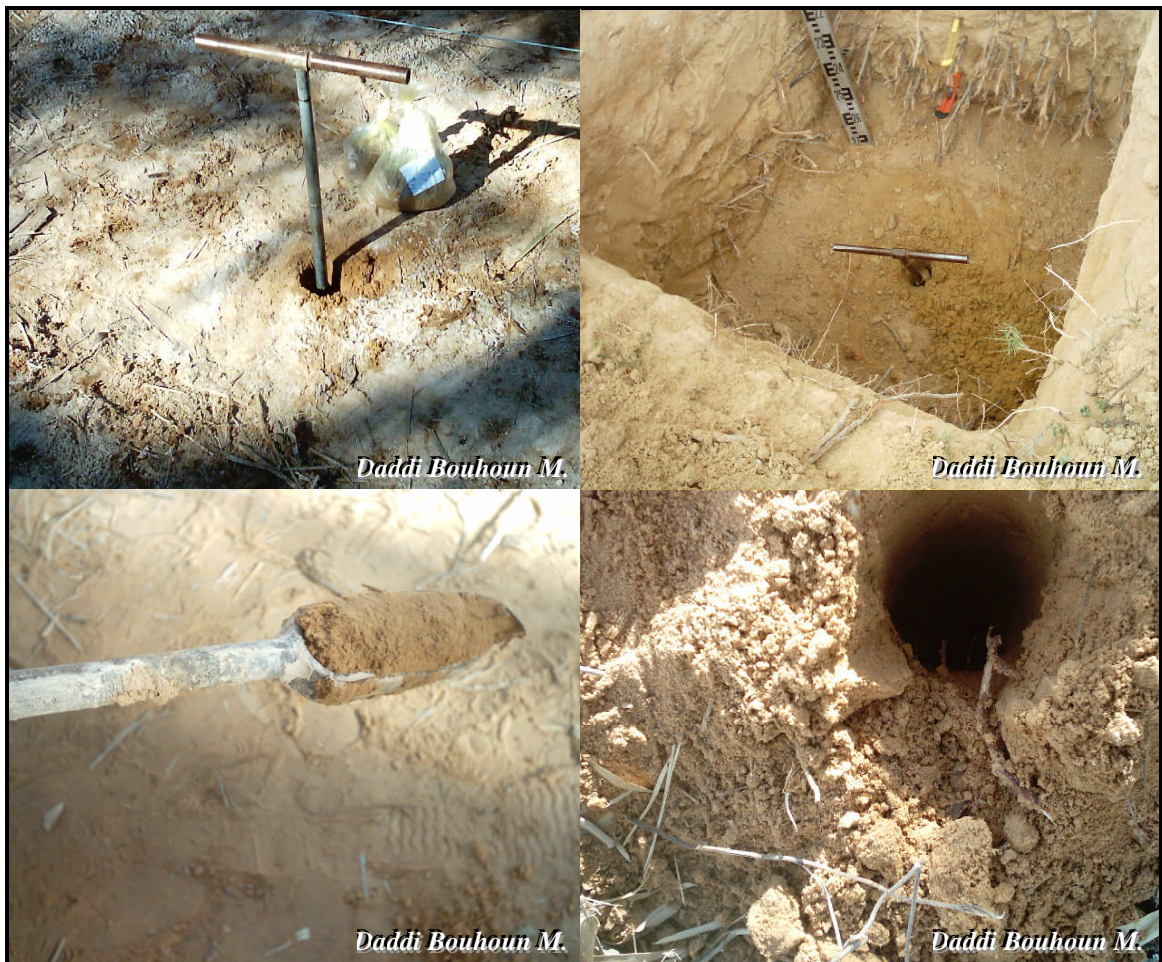
Photo VI 2. Sondage des nappes, croûtes, enracinement et prélèvements d'échantillons de sols
