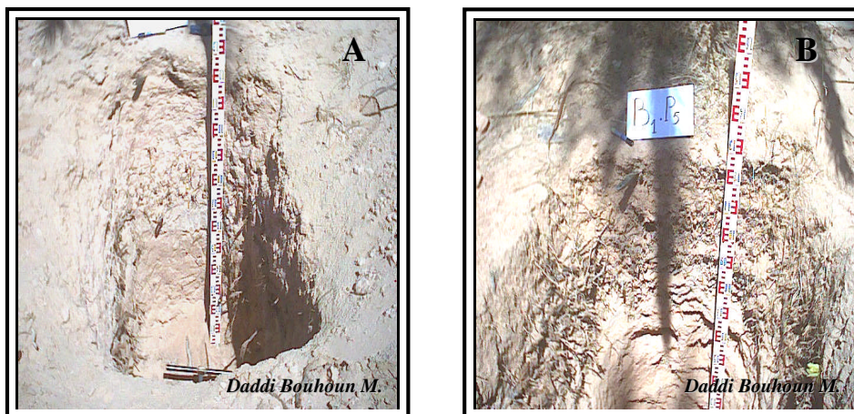
Photo VII 2. Profils des croûtes gypso-calcaires (A) et gypseuses (B) à Ouargla
