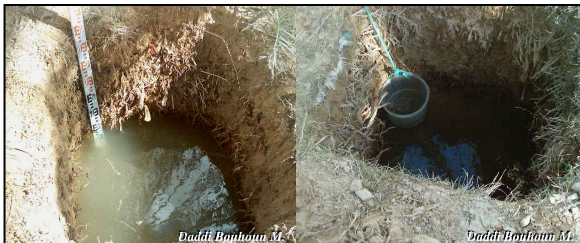
Photo VI 3. Extraction des eaux phréatiques d'un profil de nappe superficielle
