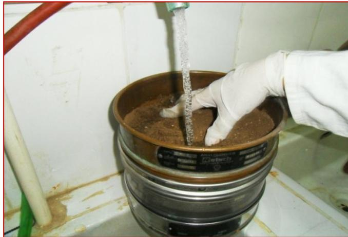
**Figure 22.** Technique d'extraction des spores fongiques par tamisage humide.
