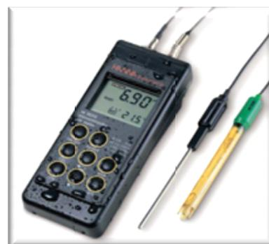
Photo IV-08 : pH-mV-T°-mètre de terrain **HI 9025**
