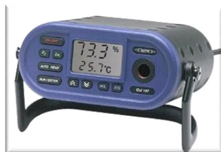
Photo IV-11 : oxymètre type WTW de terrain
