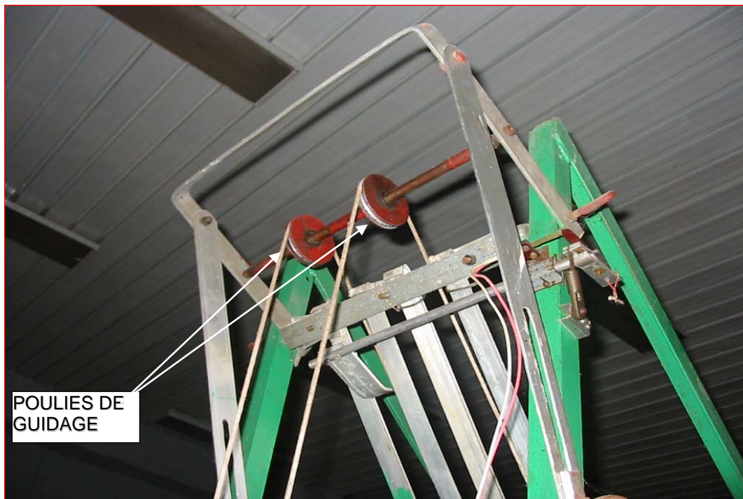
Photo 4.4 : Poulies de guidage et système d'arrêt du skip
