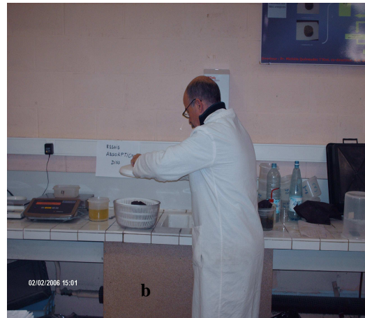
Figure 4.1 : (a) Montage pour essai d'absorption, (b) essorage de l'échantillon
