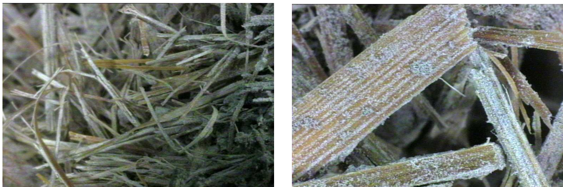
Fig 5.16 Comportement des fibres au niveau des fissures de rupture des composites de fibres de diss non bouilli, agrandissements (a) de 25 et (b) de 50.
