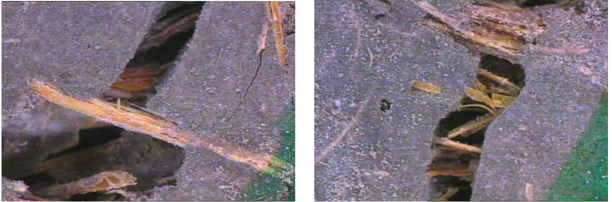
Fig 5.24 Comportement des fibres au niveau des fissures de rupture des composites de fibres de diss bouilli enrobé de huile de lin, agrandissements (a) de 50 et (b) de 50.
