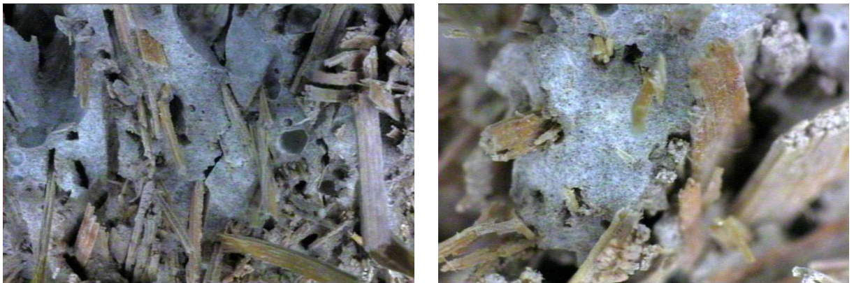
Fig 5.21 Comportement des fibres au niveau des fissures de rupture des composites de fibres de diss bouilli prémouillé, agrandissements (a) de 25 et (b) de 50.
