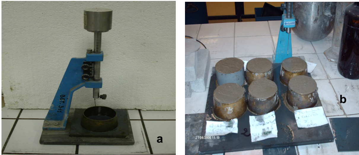
Figure 4.3 : Photographie : (a) appareil de Vicat, (b) Essais de prise
