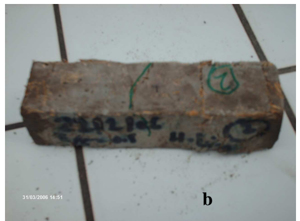
Fig 5.23 Composites de diss bouilli enrobé de huile de lin (a) après essai de flexion, (b) après essai de compression
