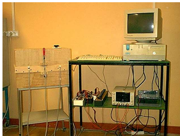
Figure 4.17 : Dispositif expérimental utilisé pour la mesure de la conductivité thermique
