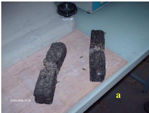
Fig 5.26 Composites de diss bouilli enrobé de bitume (a) après essai de flexion, (b) après essai de compression
