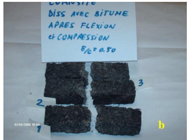
Fig 5.26 Composites de diss bouilli enrobé de bitume (a) après essai de flexion, (b) après essai de compression
