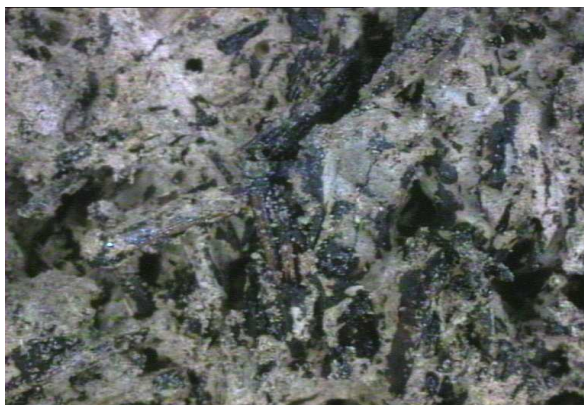
Fig 5.27 Comportement des fibres au niveau des fissures de rupture des composites de fibres de diss bouilli enrobé de bitume, agrandissements (a) de 25 et (b) de 50.
