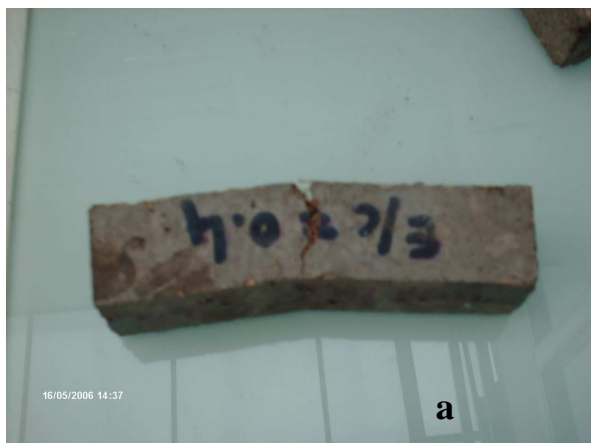
Fig 5.23 Composites de diss bouilli enrobé de huile de lin (a) après essai de flexion, (b) après essai de compression
