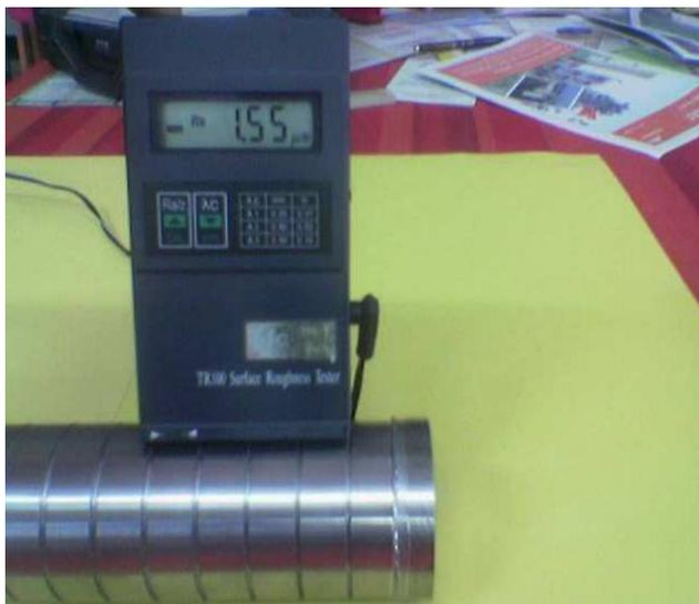
Figure II.7 Mesure de la rugosité
