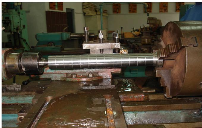
Figure II.14 Montage et préparation de l'éprouvette d'essai
