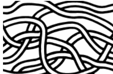
Figure I.5 : Structure d'un thermoplastique linéaire
