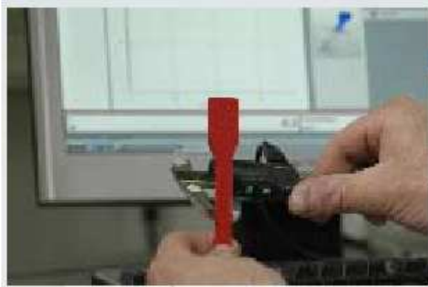
Figure.III.01. mesure des dimensions de l'éprouvette
