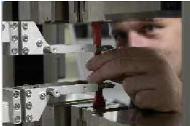
Figure.III.03. éprouvette d'essai mise en place dans la machine de traction
