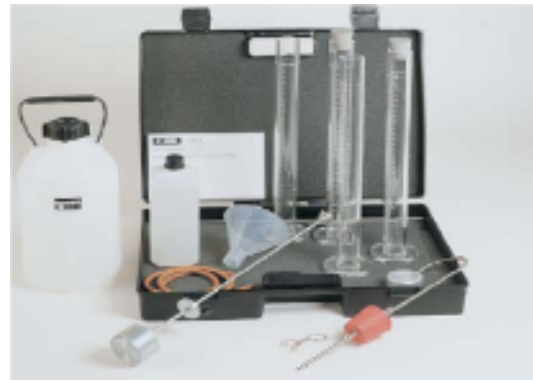
Fig.3.3. Equipement pour l'essai de l'équivalent du sable
