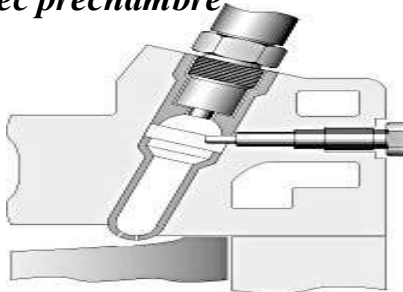
Figure 1-2 Les structures des préchambres de combustion
