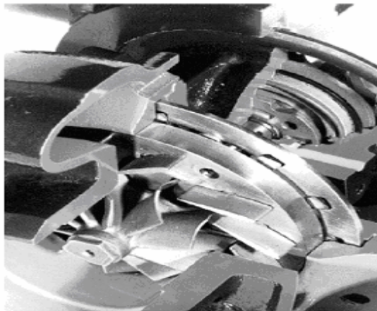
Figure 2-3 Turbine à géométrie variable à ailettes pivotantes
