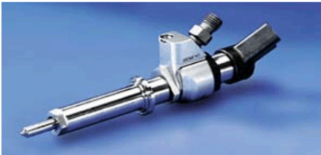
Figure 1-4 Injecteur piezo de Siemens
