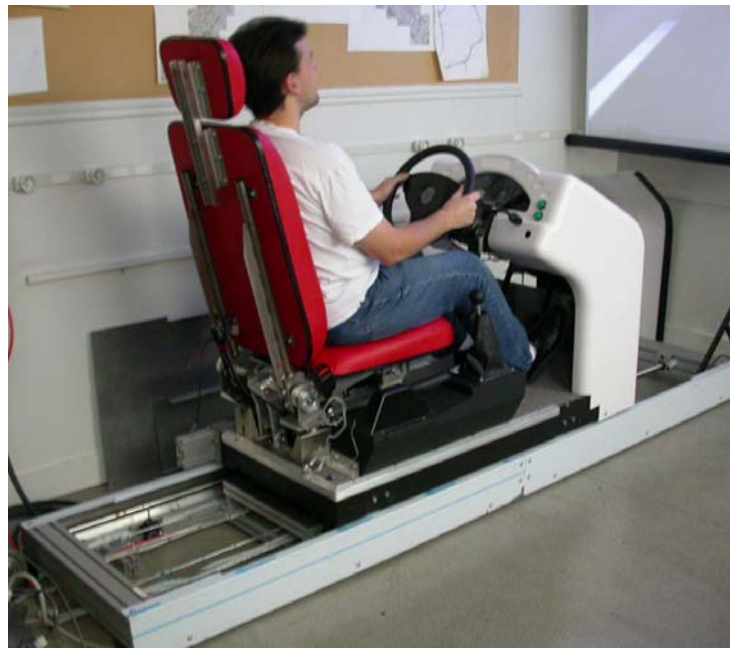
Fig 7.1 : Vue générale du simulateur de conduite de l'INRESTS -LSC
