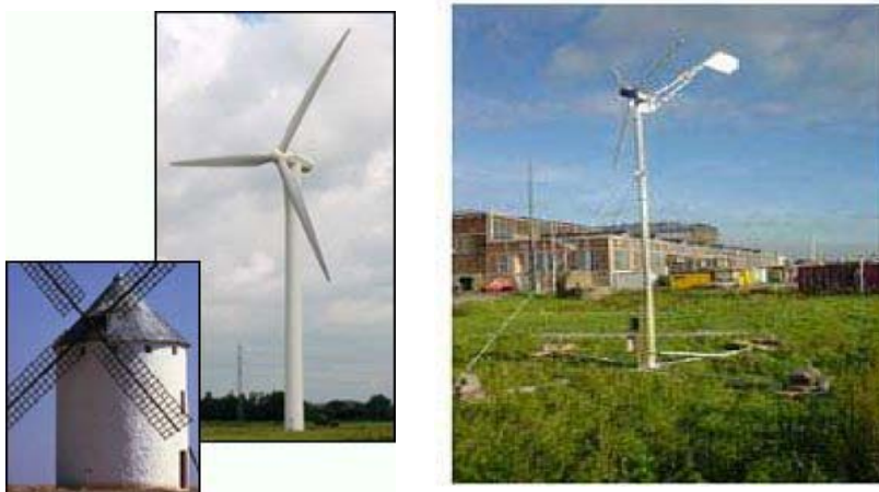
Figure 1.3 : Eolienne à axe horizontal (Modèle Fortis Montana) [17]
